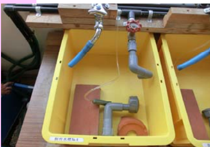
左上の蛇口が井戸水、右上が循環水。下の管から水槽の水を抜きます。本格的！
