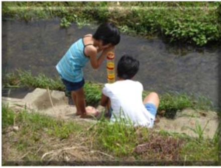
手作りの透視度計を使っています。
